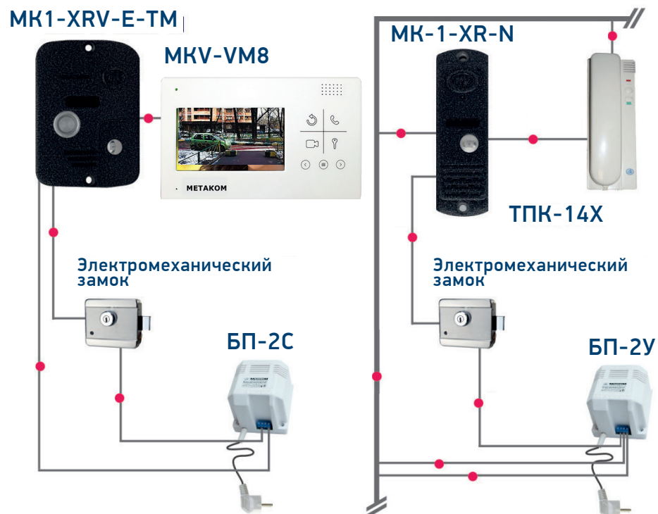
Схема подключения домофона серии МК1 video
